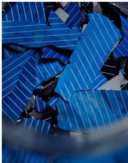
Abb 4 — Mit Lichtblitzen werden im Flaxres-Verfahren PV-Module sortenrein getrennt. Auch die einlamierten Siliziumwafer können so rückstandslos extrahiert werden • Foto: © FLAXRES GmbH
